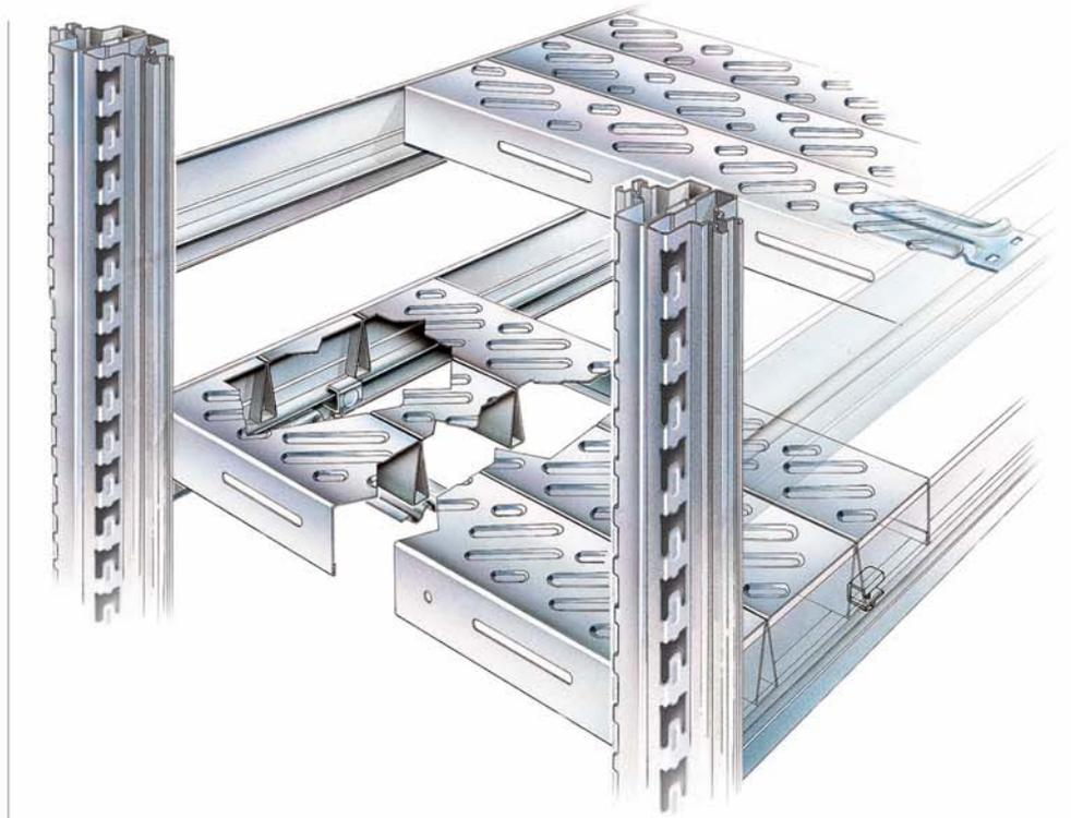
I montanti delle scale devono essere realizzati esclusivamente con montanti rinforzati della serie USR (articolo USR0--/R.95).
