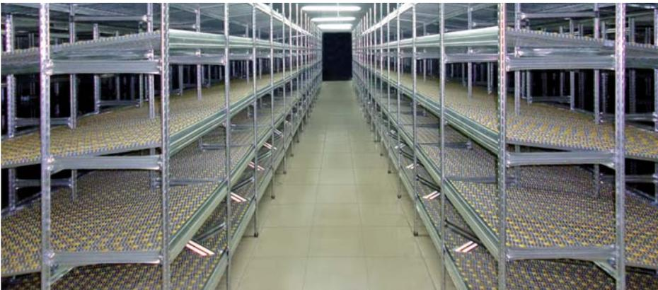
Le scaffalature a gravità funzionano secondo la logica FIFO (first in - first out). Assicurano una perfetta rotazione e visibilità delle merci e consentono di ridurre il fabbisogno di personale addetto al picking. La struttura inoltre necessita di una superficie inferiore rispetto a scaffalature tradizionali.
