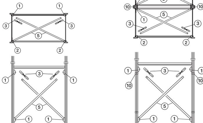
Il sistema di controvento (sia verticale che di falda) deve essere utilizzato nei casi previsti (vedi pagg. 4-5). Lo schema riportato illustra i componenti necessari per la realizzazione di un sistema di controvento per una spalla da 3000 mm in campata monofronte e bifronte.
